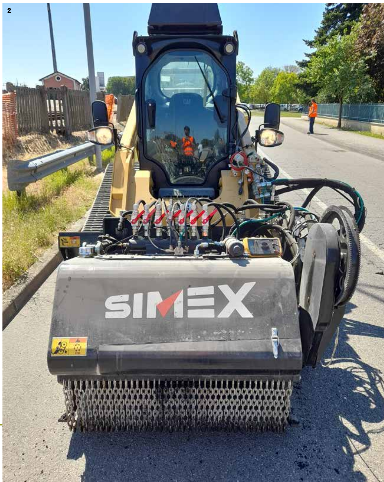
Fig. 2: Simex Art è la nuova macchina, ancora in versione prototipo, sviluppata dalla Simex Spa, caratterizzata da una fresa alla quale è stata integrata una mescolatrice.
